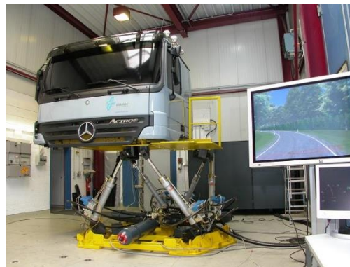
Slika 2. Stewartova platforma (levo) [2]; simulator vozil na osnovi Stewartove platforme (desno) [3].
