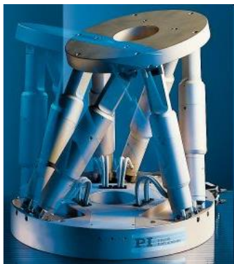
Slika 2. Stewartova platforma (levo) [2]; simulator vozil na osnovi Stewartove platforme (desno) [3].
