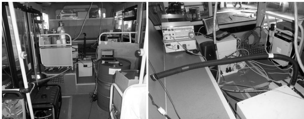
Slika 60: Namestitev opreme v avtobusih v nekaterih drugih meritvah koncentracije plinov in delcev v izpušnih plinih. Vsaka meritev zahteva dolgotrajno namestitev opreme po meri in preizkušanje posameznih podsklopov.
