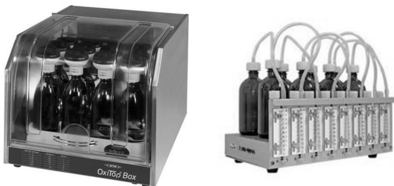
Slika 99: Merjenje BPK z metodo respiracije, levo: steklenice Oxitop imajo na vrhu v merilni glavi nameščen manometer, hkrati morajo biti nepredušno zaprte. Desno: merjenje tlaka z U cevnimi manometri [www.wtw.com in www.jingkeyiqi.com].
