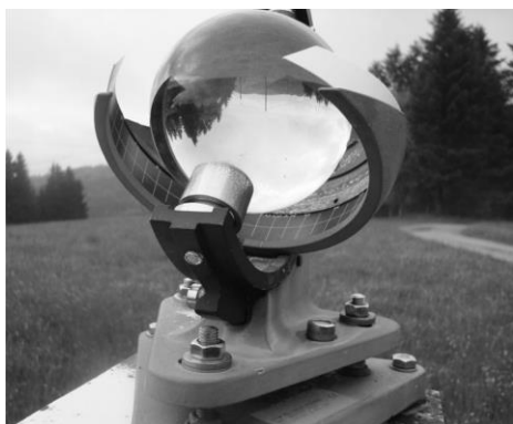
Slika 23: Heliograf, levo merilnik, desno trak v njem [ www.podlipa-smrecje.si in www.wikipedia.org ]
