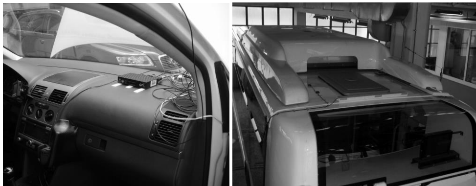
Slika 62: Meritve lege vozila in atmosfere meritve, levo: sprejemnik signala GPS v avtomobilu z vgrajenim merilnikom pospeška ter analognimi in frekvenčnimi vhodi za spremljanje parametrov vozila, desno: dve anteni GPS na strehi avtobusa in namestitvev merilne opreme za merjenje okoljskih parametrov.
