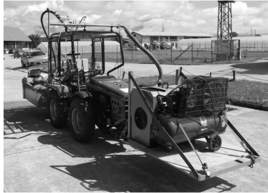
Slika 2: Merjenje koncentracije onesnažil v izpušnih plinih motornih vozil. Levo: shema delovanja plamensko ionizacijskega analizatorja plinov (FID) in desno: sistem za merjenje koncentracije plinov in masnega toka delcev v izpušnih plinih vozil. Med shemo delovanja posameznega analizatorja in praktično izvedbo meritev npr. za premične vire onesnaževanja ali velike kanale dimnih plinov v termoelektrarnah je velika razlika.
