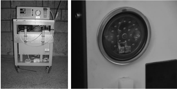
Slika 49: Levo: merjenje koncentracije dimnih plinov z IR-analizatorjem dimnih plinov Siemens Ultramat 22, pod analizatorjem pa je hladilnik vzorčenih dimnih plinov. Na sliki sta dve stekleni posodi z vato za odstranjevanje trdnih delcev iz dimnih plinov. Dimni plini prehajajo skozi obe posodi zaporedno. Na analizatorju je na desni strani pred elektrokemičnim zaznavalom za merjenje koncentracije kisika dodatni filter za kondenzat in v njem grobi filter za trdne delce. Na sredini analizatorja je še en bolj fin papirnati filter pod steklenim pokrovčkom. Desno od prikazovalnika je rotametrični merilnik prostorninskega toka s kroglico, ki lebdi v toku dimnih plinov. Desno: v analizatorju plinov ABB je pod filtrom črpalne enote nameščeno zaznavalo vlage. Če se na filtru nabere kapljevita voda, se zmanjša upornost med obema kontaktoma in delovanje črpalke ter analizatorja se prekine.
