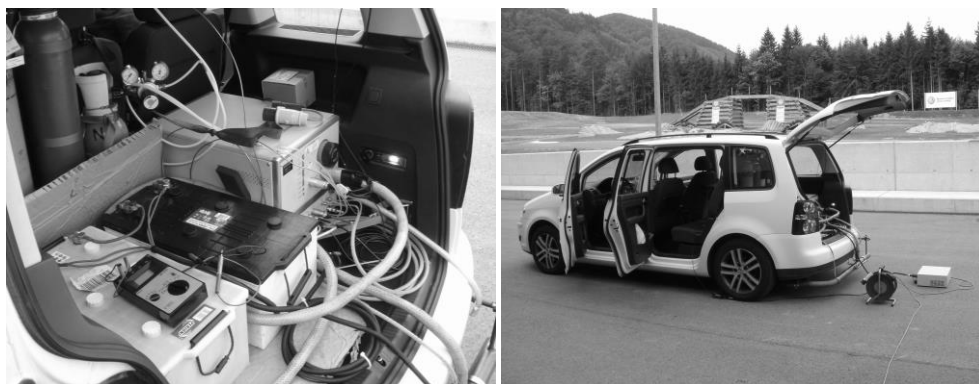
Slika 56: Merilni sistem za merjenje koncentracij v izpušnih plinih, levo: namestitvev akumulatorjev in jeklenk z dvostopenjsko nastavitvijo tlaka in desno: polnjenje akumulatorjev.
