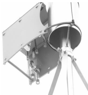
Slika 45: Ohišje z večdifuzivnimi vzorčevalniki, ohišje je nameščeno na drog javne razsvetljave [Kakovost zraka v Sloveniji v letu 2011, 2012].
