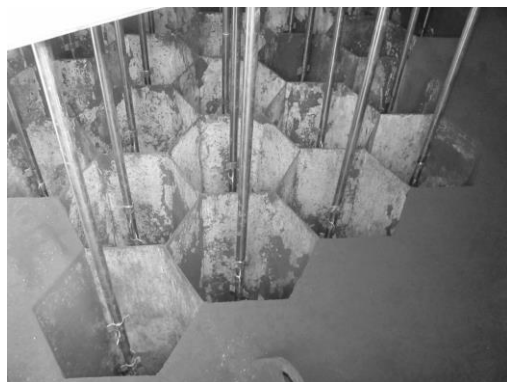
Slika 75: Cevna vrsta elektrostatičnih filtrov, levo: zbiralne elektrode, desno: zbiralne elektrode z vstavljenimi palicami - negativno nabitimi elektrodami [www.wikipedia.org].
