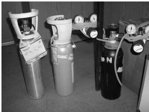
Slika 50: Jeklenke s kalibracijskimi plini in reducirnimi ventili. V levi jeklenki je kalibracijski plin zmešan z dušikom, v srednji jeklenki je kisik in v desni jeklenki dušik.
