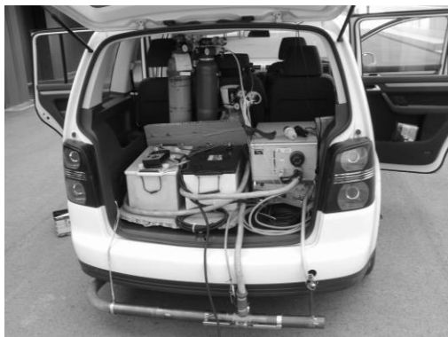
Slika 53: Merilni sistem za merjenje sestave izpušnih plinov vozil med vožnjo. Spodaj pod odbijačem je na izpušno cev nameščen sistem za odjem izpušnih plinov, izdelan s strani izdelovalca merilne opreme. Iz sistema za odjem vodi tanka svetla cev s tlačnimi odjemi za meritve pretoka in s termočlenom za merjenje temperature in debela ogrevana in toplotno izolirana cev za odjem izpušnih plinov za analizator. V prtljažnem prostoru so plinske jeklenke s kalibracijskimi plini (zmes CO, CO 2 , propan in NO), sintetičnim zrakom (kisik in dušik) in gorivom za celico FID (zmes vodika in helija). Spredaj levo so akumulatorji za napajanje celotnega sistema. Desno je analizator izpušnih plinov Horiba OBS 2200. Pokrovček črne barve pokriva mesto, kjer je nameščen filter za delce.
