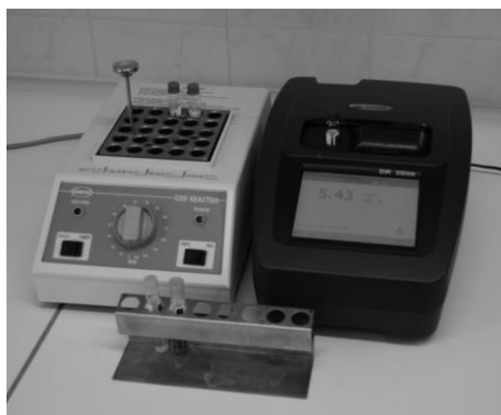
Slika 100: Spektrofotometrične meritve, levo: spektrofotometer z vstavljeno okroglo kiveto, grelnikom in stojalom za kivete, desno: načelo delovanja enožarkovnega spektrofotometra
