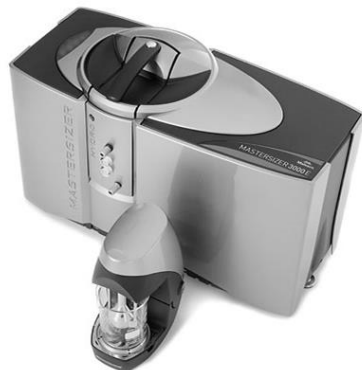
Slika 32: Laserski difraktometer, levo: shema delovanja, desno: izvedba, vrste Malvern Mastersizer 3000E [www.malvern.com].
