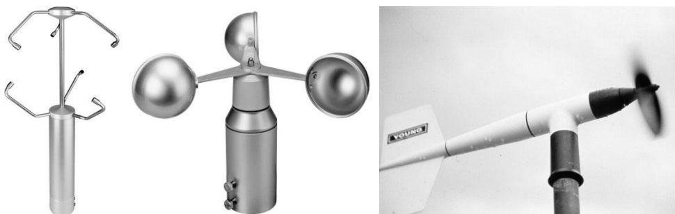
Slika 21: Anemometri, ki se uporabljajo pri meteoroloških meritvah: ultrazvočni anemometer (skrajno levo), anemometer s skodelicami (v sredini), anemometer na vetrnico (desno) [ www.thiesclima.com , www.fuehlersysteme.de in www.inspectapedia.com ].
