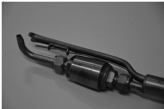
Slika 26: Izokinetično vzorčenje v toku, ki vsebuje delce, levo načelo delovanja izokinetičnega vzorčenja in v sredini slika izokinetičnega zaznavala. Na levi sliki je izokinetična metoda prikazana na primeru w = c , to je povsem levo. Na sliki v sredini je vzorčevalni del izokinetičnega zaznavala steklen, del za merjenje hitrosti in del za merjenje temperature sta iz nerjavnega jekla. Zaznavalo je 'in stack', to pomeni, da je filter, skozi katerega teče plin, v dimniku. Desno: 'in stack' filter izokinetičnega zaznavala vsebuje mesto, kamor se namesti filter za analizo delcev.
