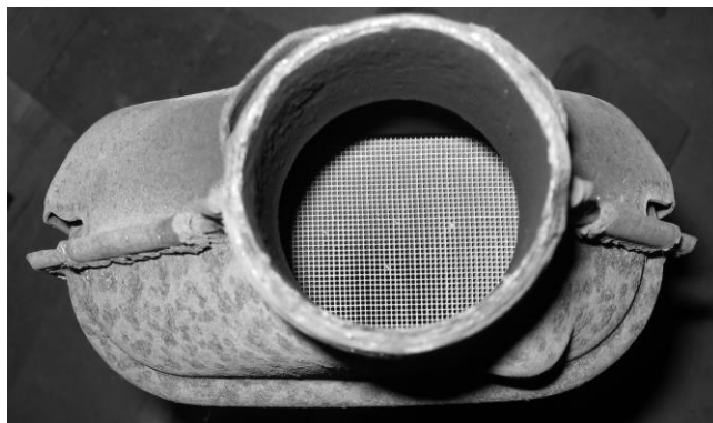
Slika 87: Izrabljen avtomobilski katalizator, keramično jedro s satasto strukturo [www.wikipedia.org]
