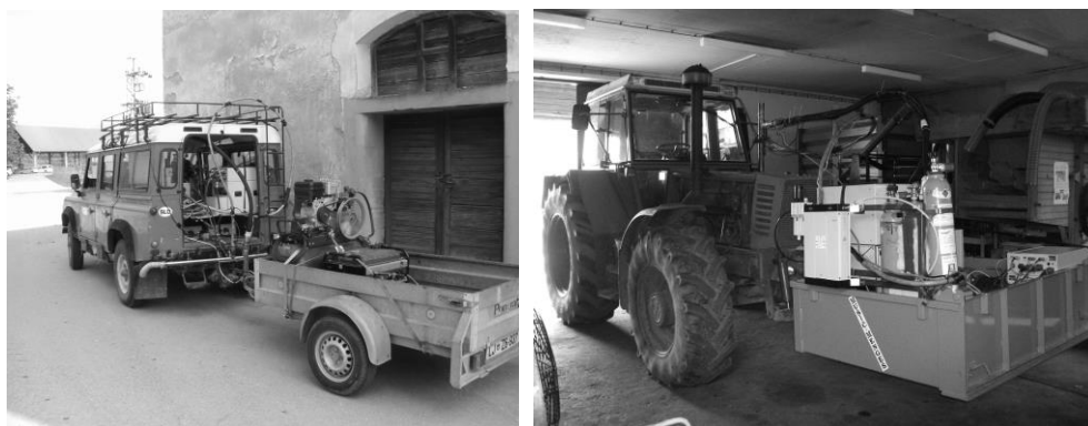
Slika 61: Namestitev opreme na traktorjih in terenskih vozilih. Vozila so med meritvami delovala na različna goriva: dizel, biodizel in hladno stiskano rastlinsko olje.
