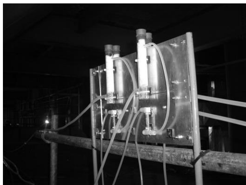
Slika 47: Priprava za zagotavljanje enakega prostorninskega toka skozi dve odjemni mesti. Spodaj sta dva rotametrična merilnika prostorninskega toka s kroglico in igelnim ventilom za izenačevanje prostorninskih tokov v obeh odjemnih vejah. Zgoraj je filter za trdne delce in vata v stekleni cevki.
