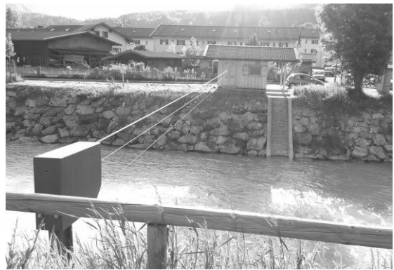
Slika 89: Postopek merjenja prostorninskega toka vodotoka s hidrometričnimi krilci ali z ultrazvočnimi anemometri. Levo: shema razporeditve lamel in desno naprava za merjenje prostorninskega toka vodotoka, Isar, Mittenwald, Nemčija.
