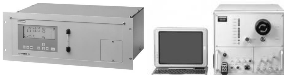
Slika 35: Levo: analizator dimnih plinov Siemens Ultramat 23. Analizator deluje po metodi infrardeče spektroskopije, za merjenje koncentracije kisika pa ima vgrajen (desno spodaj, kjer je ploščica, ki se privijači na sprednjo ploščo analizatorja) elektrokemično celico za merjenje koncentracije kisika. Desno: analizator izpušnih plinov Horiba OBS 2200 za uporabo v motornih vozilih v realnem prometnem toku deluje na načelu infrardeče spektroskopije, plamenske ionizacijske detekcije in kemiluminiscenčne metode [www.siemens.com in www.horiba.com].
