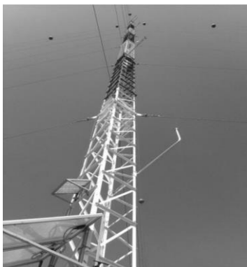
Slika 22: Merjenje hitrosti vetra na lokaciji Kanalski Vrh zraven zgornje akumulacije ČHE Avče [Levpušček, 2012]
