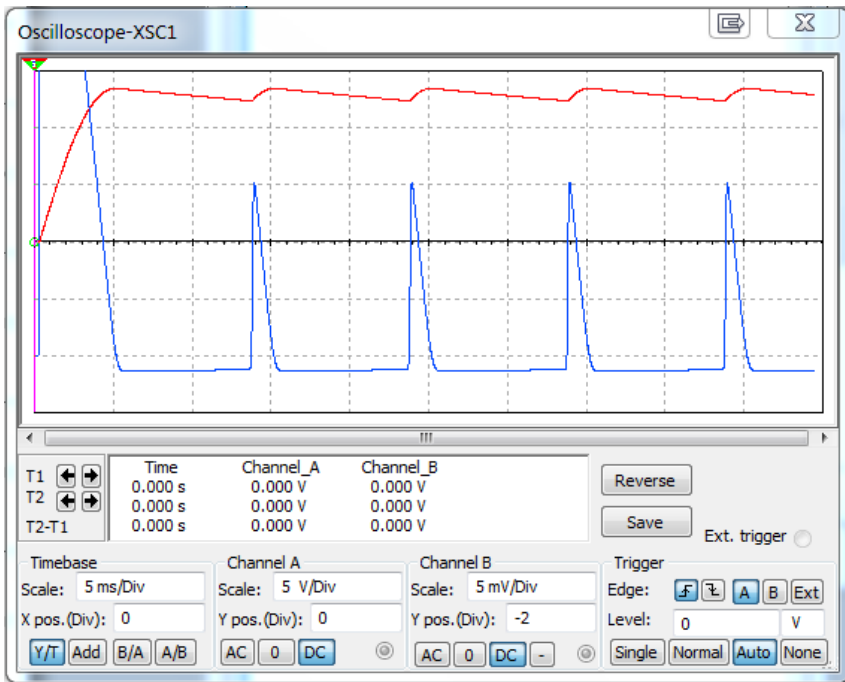
Slika 18.8: Napetost na bremenu in tok kondenzatorja za vezje na sliki 18.7
