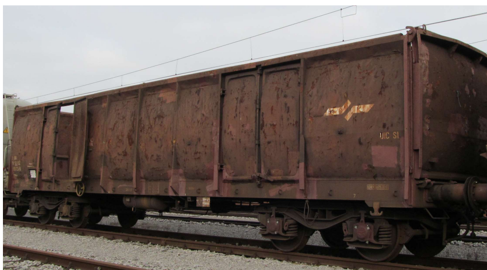
Slika 110: Štiriosni odprti škatlasti vagon podserije Eas-z
