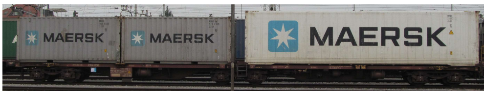
Slika 108: Zgibni ploščni vagon podserije Sggrss s tremi podpornimi vozički in naloženima dvema 20' ter enim 40' kontejnerjem
