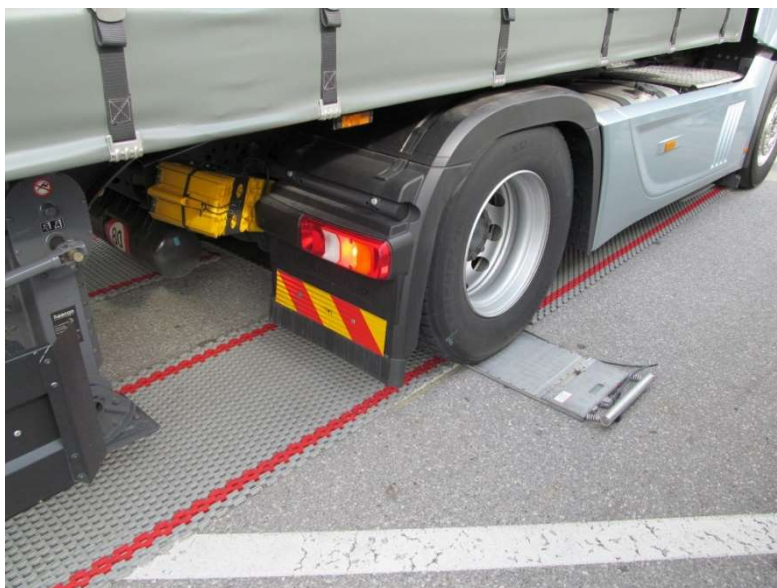
Slika 80: Tehtanje osne obremenitve vozila na prenosni tehtnici
