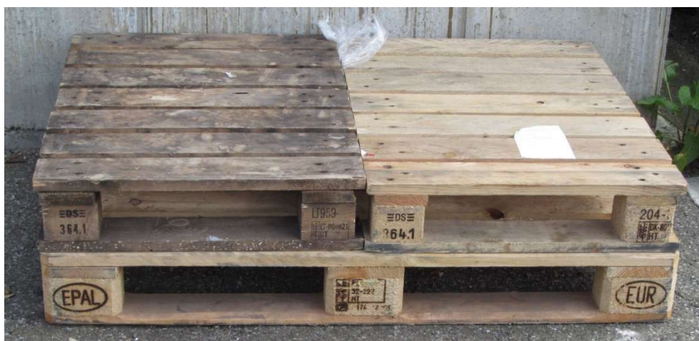
Slika 146: Sklad "euro" palet (spodaj 800 × 1200 mm, zgoraj 800 × 600 mm)
