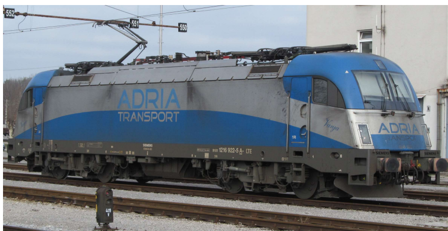
Slika 103: Večsystemska električna lokomotiva Siemens ES64U4
