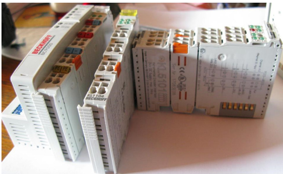
Slika 4: Programabilni modularno grajen logični krmilnik Beckhoff®
