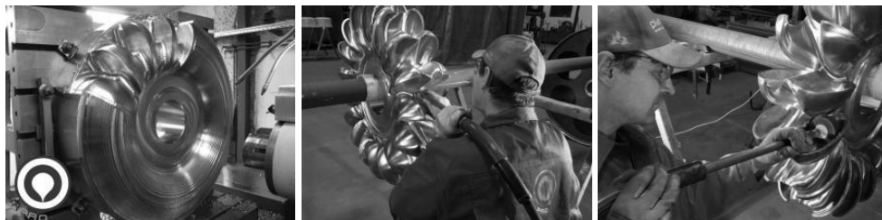
Slika 26: Izdelava gonilnikov Peltonovih turbin; levo: izdelava lopatic Peltonove turbin na frezalnem stroju, gonilnik je iz enega kosa; v sredini in desno: brušenje gonilnika Peltonove turbine [z dovoljenjem: Siapro d.o.o., www.siapro.eu ]
