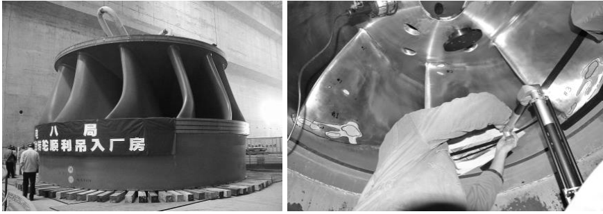
Slika 10: Levo: gonilnik Francisove turbine, elektrarna treh sotesk, Kitajska [vir: https://en.wikipedia.org/ ]; desno: gonilnik črpalne hidroelektrarne Avče - merjenje kavitacijske erozije z merilno roko, pogled na gonilnik iz sesalnega konusa [z dovoljenjem: SENG d.o.o.]
