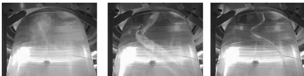
Slika 87. Različne vrste kavitacijskih vrtincev v Francisovi turbini, [z dovoljenjem: Kolektor Turboinštitut d.o.o.].
