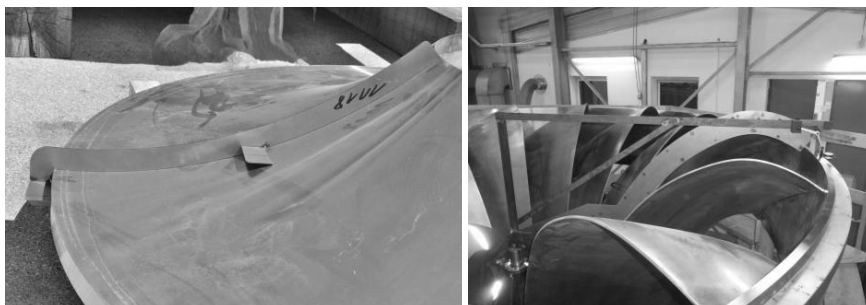
Slika 30: Postavitev lopatic med pesto in obroč. Lopatice so po litju ali krivljenju obdelane s 3D rezkarjem, dobro nalegajo med pesto in venec po površini in jih je treba enakomerno razporediti po obodu [z dovoljenjem: Andino d.o.o.].
