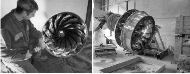
Slika 32: Izdelava Francisovega gonilnika; levo: brušenje Francisovega gonilnika [z dovoljenjem: Siapro d.o.o., www.siapro.eu ]; desno: postopek penetracije zvarov za določitev poškodb v materialu [z dovoljenjem: Andino d.o.o.]
