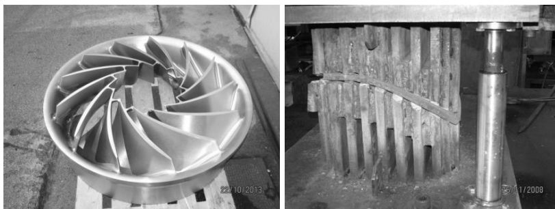
Slika 28: Izdelava gonilnikov Francisovih turbin; levo: izdelava manjšega gonilnika Francisove turbine z rezkanjem; desno: izdelava lopatic s krivljenjem [z dovoljenjem: Andino d.o.o.]
