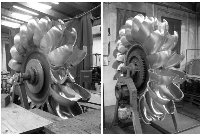
Slika 27: Gonilnik Peltonove turbine s skoraj vsemi navarjenimi lopaticami [z dovoljenjem: Andino d.o.o.]
