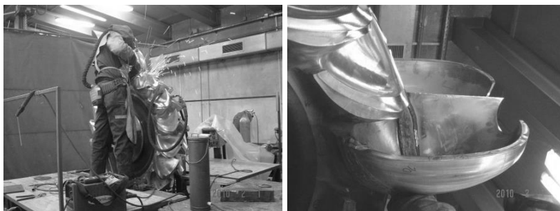
Slika 25: Izdelava gonilnika Peltonove turbine; levo: brušenje gonilnika pred varjenjem lopatic; desno: varjenje lopatic [z dovoljenjem: Andino d.o.o.]
