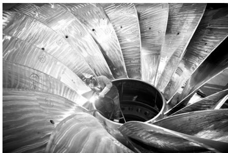
Slika 24: Varjenje velikega gonilnika Francisove turbine [vir: https://www.ewm-group.com ]
