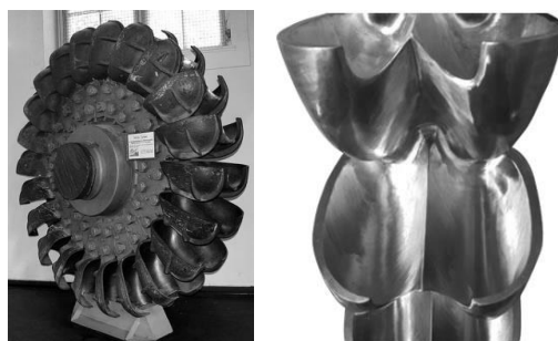
Slika 7: Gonilnik Peltonove turbine; levo: stari gonilnik Peltonove turbine iz ČHE Walchensee, Nemčija [vir: https://en.wikipedia.org ]; desno: podrobnosti oblike lopatice [z dovoljenjem: Andino d.o.o.]
