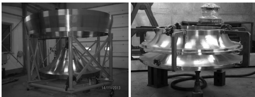
Slika 29: Izdelava gonilnika Francisove turbine, poravnava pesta in obroča, [z dovoljenjem: Andino d.o.o.]
